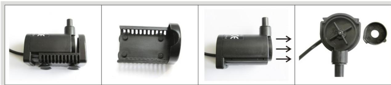
Si après quelque temps la pompe commence à être moins efficace ou ne fonctionne plus, nettoyer le calcaire situé dans la doublure de la pompe. Noter bien que la pompe peut être ouverte en appuyant vers le bas au fond du boîtier (voir la photo ci-dessus pour la démonstration). Pour dégager le rouet centrifuge, ouvrir le boîtier de la pompe à l'avant en faisant glisser le couvercle en plastique de devant.
